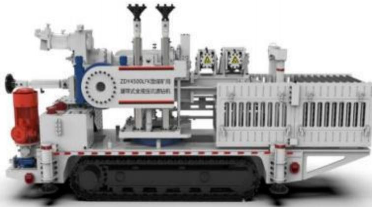
ZDY4500LFK 型煤矿井下智能钻机主要用于瓦斯抽采、冲击地压防治、探放水、地质构造探测等多种钻孔的全自动施工。该型钻机一次携带 200 根钻杆，可不间断施工 150 米，并具备自主导航功能，可自主行驶至作业面。根据钻孔设计信息，钻机可完成全自动稳固和智能调姿。其中的分布式电液控制系统实现了关键传感器的工作状态监测和故障自诊断，先进的集中控制及交互系统实现地面、井下对钻机集群的集中管理。该型钻机还具有自适应钻进功能，可大大提高钻进效率和孔内安全性。该装备的成功应用可提高钻孔施工自动化水平，降低工人劳动强度，提高人均钻孔施工效率，起到减人增效的作用。
